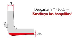
Extracto de la ISO 5057: "En caso de desgaste del 10% del grosor original de la horquilla, ésta debe ser retirada del servicio". El 10% de desgaste ya supone la reducción de la capacidad de la horquilla en un 20%. La base para la medición del desgaste es el grosor nominal original (n) de la horquilla (p.ej. grosor nominal (n) = 40 mm -> límite de desgaste = 36 mm). Las horquillas desgastadas no deben ser soldadas.
