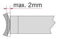
Las fuerzas laterales y el uso a largo plazo pueden causar doblados laterales del enganche de la horquilla. En este caso, deben sustituirse los enganches o las horquillas.
