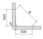
Las horquillas se suministran con un ángulo de 90°. Están diseñadas con un factor de seguridad 3, es decir, una única triple carga nominal no conduce a una flexión permanente. Sin embargo, la sobrecarga constante o el mal uso pueden ocasionar deformaciones permanentes.
