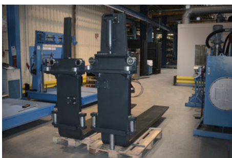
Horquillas 400 x 80 mm, guiadas por rodillos y con altura ajustable
