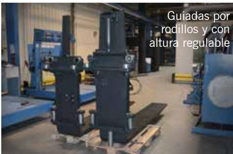
Guiadas por rodillos y con altura regulable
