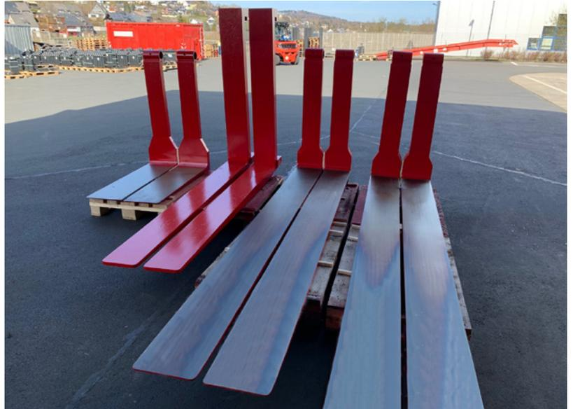
VETTER a développé les BigForks « FTP » (**Fully Tapered Polished** - entièrement biseautées et polies) pour l'industrie du bois, avec une **largeur de fourche de 400 mm**. Cela garantit une **répartition optimale du poids des emballages** sur les fourches et empêche de marquer le matériau. Le plat de la fourche est très fin (**cela peut aller jusque 5 mm d'épaisseur à la pointe**) et biseauté sur toute sa longueur. Il est ainsi beaucoup plus facile d'insérer la fourche
