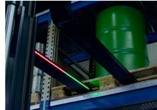
LEDs innenliegend. Frei programmierbar zur Einfahrtiefenbestimmung.
