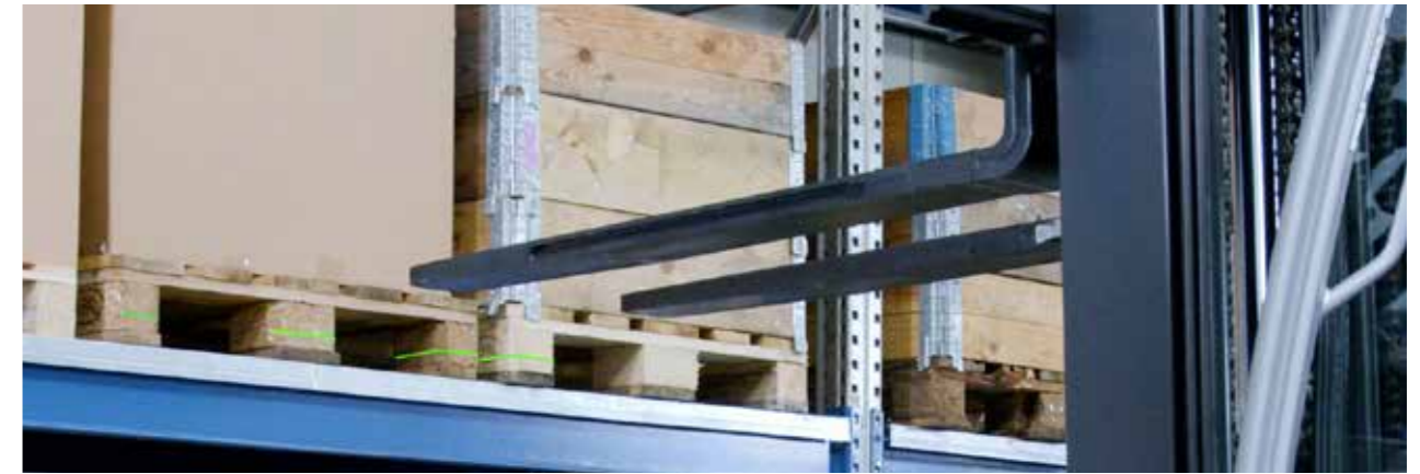
Präzises Anvisieren. Grüner Laser in der Gabelzinkenspitze.
