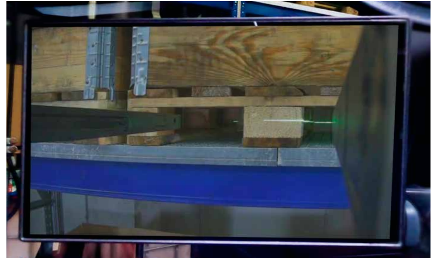
Monitoransicht im Fahrerhaus. Zielen entlang der Gabelzinke
