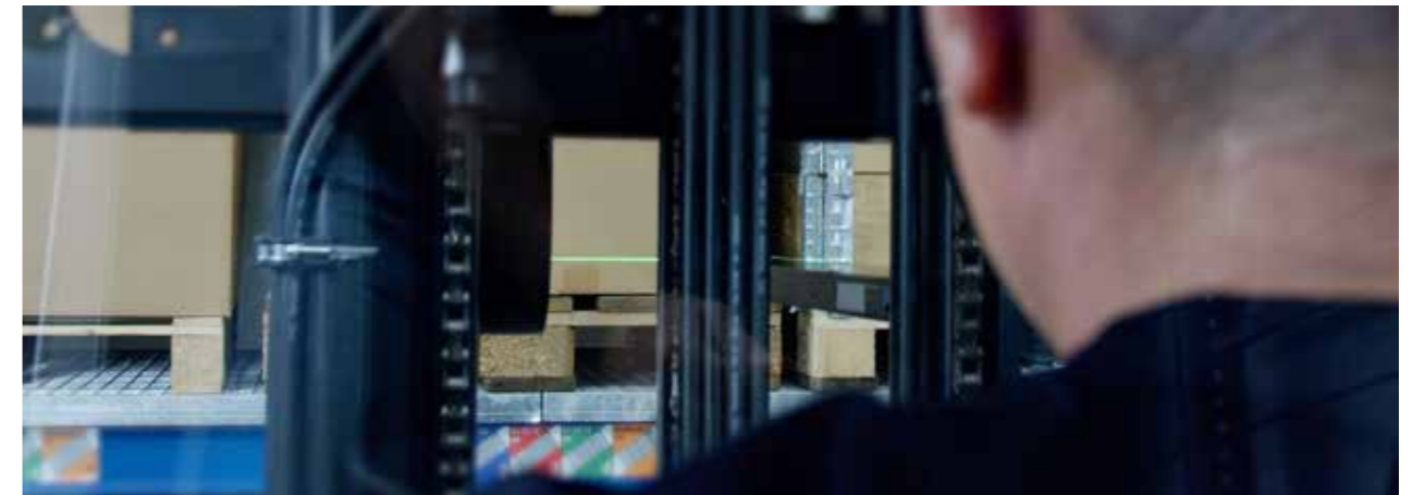
Anvisieren mit Laser aus Fahrersicht.
