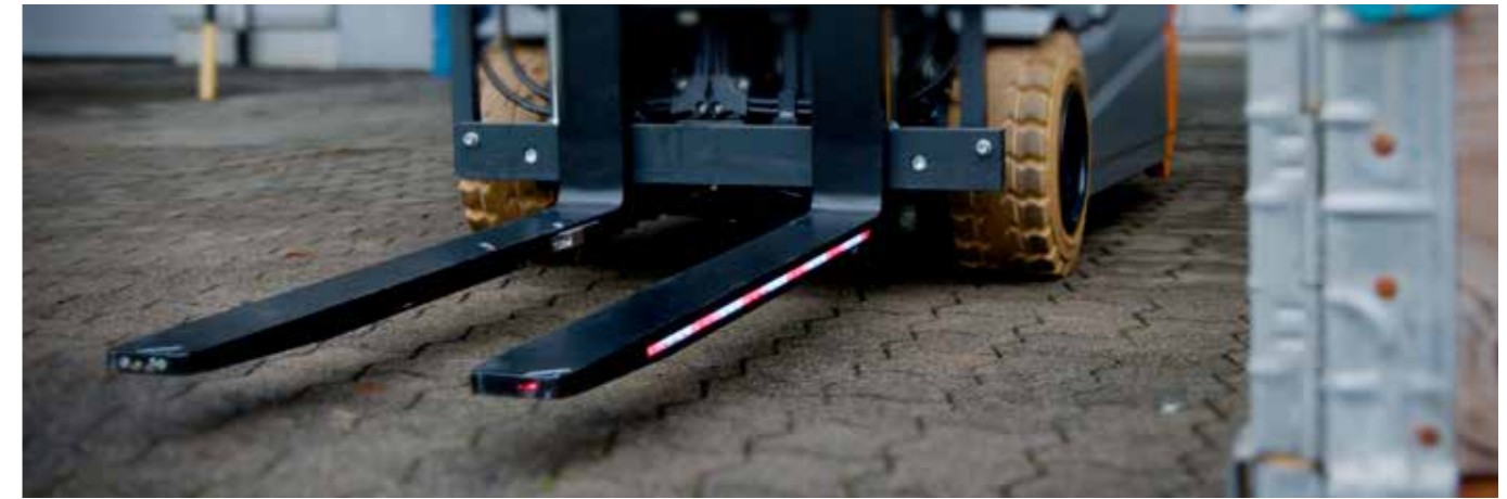
LEDs seitlich in der Gabelzinke integriert. Warnfunktion in unübersichtlichen Situationen.
